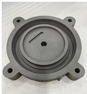
子供用おもちゃのタイヤ金型雄型（実生産ステンレスまたは金型鋼）
